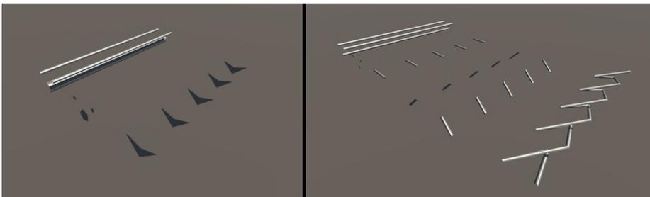
**Figura 2.2:** Separação dos modelos de trilho em partes mais simples. À esquerda, estão as partes do modelo baseado no trilho *Vekoma new spine* e, à direita, estão as partes do modelo baseado no trilho *Intamin 3-pipe*. As faces que não estão direcionadas à câmera não estão visíveis por causa do pipeline de renderização.
