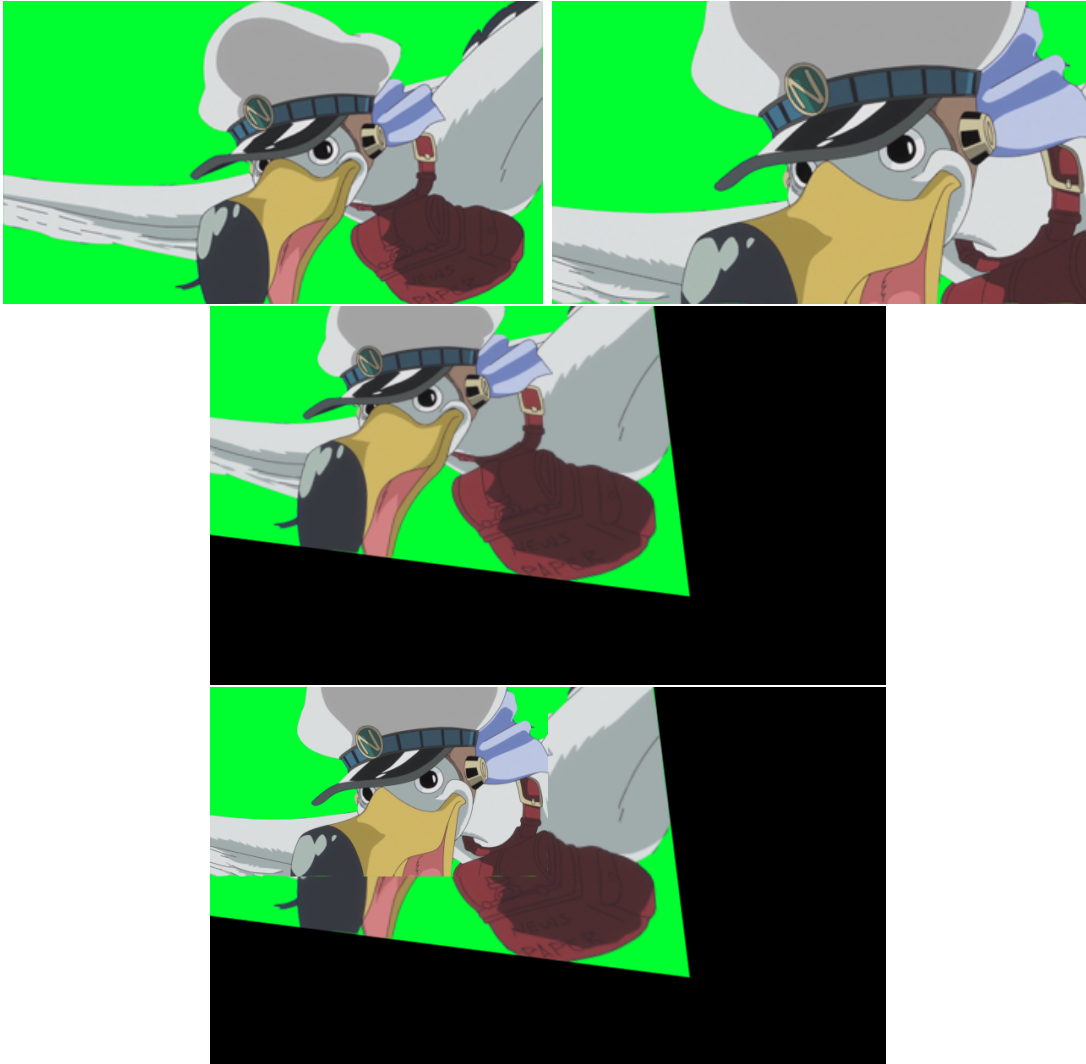
Figura 3.8: No topo, os dois frames originais. Em seguida, o primeiro frame após ser transformado pela homografia H em relação aos keypoints correspondidos entre os dois frames. Por último, o segundo frame sobreposto na imagem transformada.
