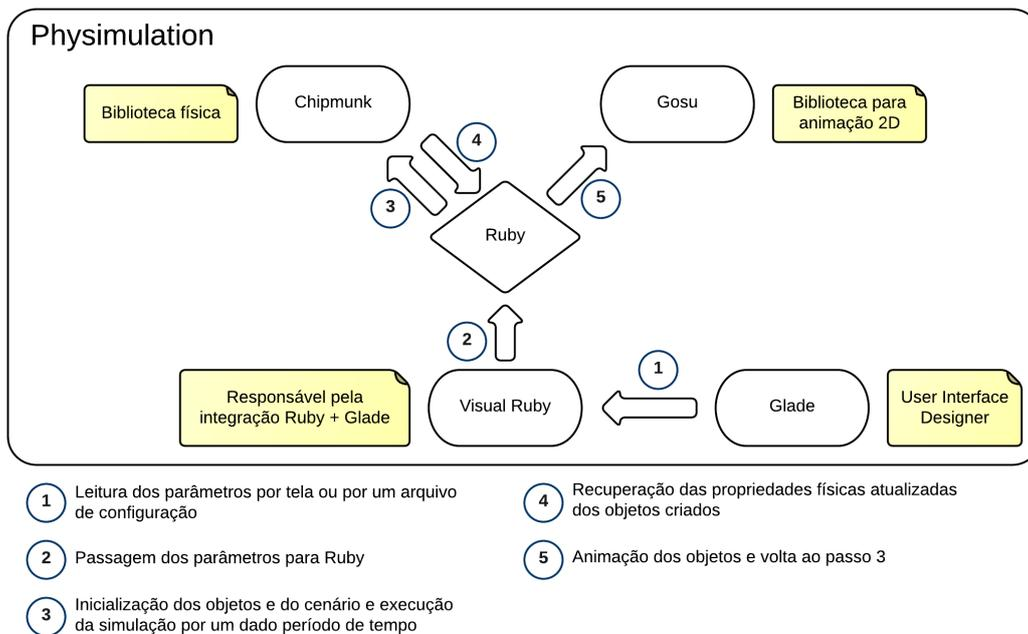
Figura 1: Esquema de dependências do Physimulation
