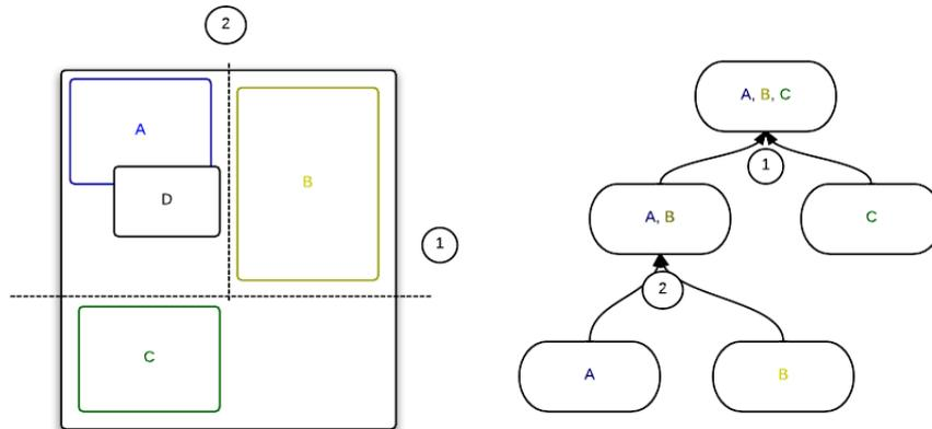
Figura 4: Exemplo de detecção de colisão. O objeto D é comparado somente com a folha contendo o objeto A.
