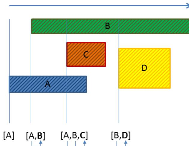
Figura 5: Exemplo de funcionamento do algoritmo *sweep and prune* [4]
