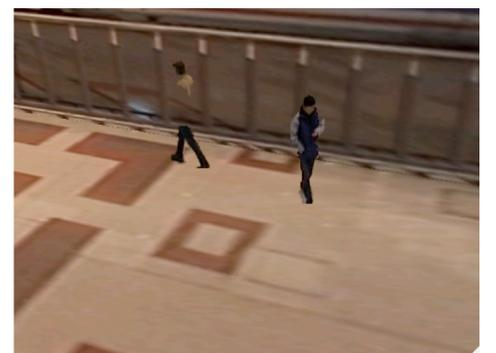
Exemplo de uma máscara de segmentação com falhas, gerando erros na renderização das pessoas. Parte do corpo da pessoa a esquerda não é renderizada.
